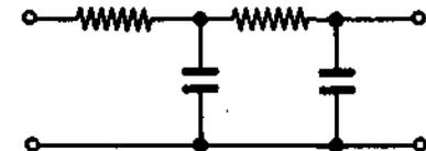
**FILTRE À SELF EN TÊTE ET À CELLULE** — C'est un circuit filtre qui se compose d'une self de filtrage montée en série avec les bornes de sortie du redresseur, et d'un condensateur de filtrage branché sur les bornes extérieures. La tension de sortie ondulée représente entre 3 et 10 pour cent de la tension de sortie continue.
