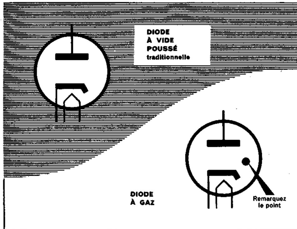
Comme vous le voyez dans le schéma ci-dessus, le tube à gaz comporte le même genre de fil de chauffage et de cathode que la diode usuelle. Beaucoup de tubes à gaz comportent des cathodes à chauffage direct semblables à celle utilisée dans le tube redresseur à vide poussé du type 80. La fonction de la cathode est la même dans les deux types de tubes. Elle consiste à émettre des électrons.
