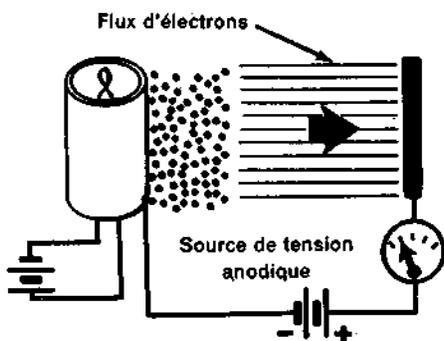
Lorsqu'on double la tension anodique, le courant est également doublé. Le principe de fonctionnement d'une diode est donc le suivant : Tant que la plaque est positive par rapport à la cathode, tout changement de tension anodique provoque un changement proportionnel du courant anodique.
