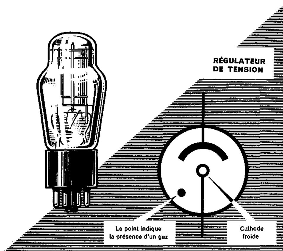
Lorsque la tension appliquée entre la cathode et la plaque (anode) est suffisamment grande, le gaz dans le tube conduit le courant et il se produit un flux d'électrons de la cathode vers la plaque. Quand il y a conduction d'un courant, une lueur bleuâtre apparaît à l'intérieur du tube. Plus le flux d'électrons est grand plus la lueur est forte.
