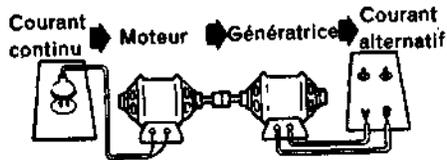
**CONVERTISSEUR** — Le convertisseur est une machine rotative à courant continu qui est alimentée par une basse tension continue et fournit une ou plusieurs tension(s) continue(s) élevée(s). Un convertisseur se compose essentiellement d'un moteur et d'une génératrice à courant continu, réunis de façon à former une seule machine et comportant deux collecteurs ou plus.
