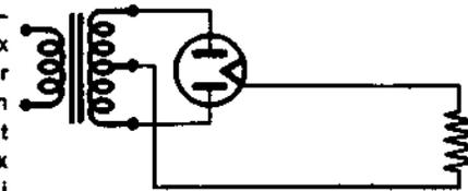
**TUBE REDRESSEUR DOUBLE ALTERNANCE** — C'est un tube à vide qui se compose de deux diodes spécialement destinées à cet emploi et d'une cathode qui leur est commune, les trois étant entourées d'une ampoule de verre. On utilise, soit des cathodes à chauffage direct, soit des cathodes à chauffage indirect, selon que le circuit redresseur nécessite l'une ou l'autre des deux solutions.
