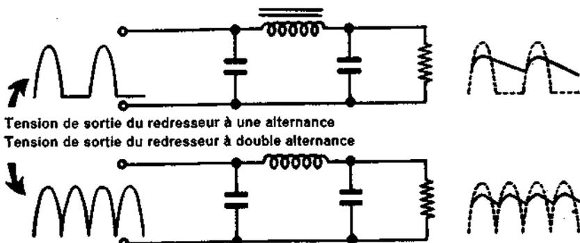
Plus la fréquence de la tension d'entrée alternative est grande, plus la valeur des condensateurs de filtrage peut être petite. A des fréquences élevées, il s'écoule moins de temps entre deux pulsations consécutives, et l'action inductive de la self est plus forte.
