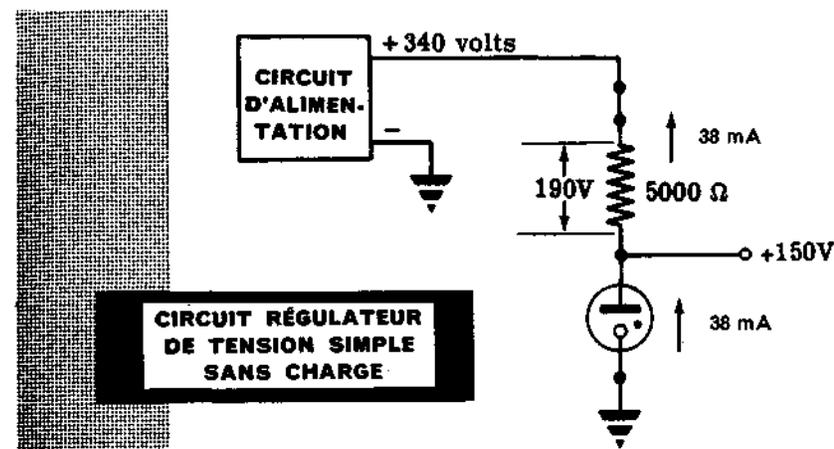
Supposez que vous branchez sur la borne de 150 volts une charge consommant 8 mA. Des 38 mA dans la résistance chutrice, 8 mA passent par la charge et 30 mA passent par le tube régulateur. Puisque le courant dans le tube régulateur est toujours dans les limites de la valeur nominale, qui est de 5 à 40 mA, le tube adapte sa résistance interne de sorte que la tension anodique reste à 150 volts.
