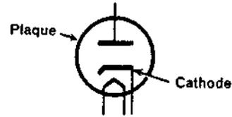
**ÉMISSION ÉLECTRONIQUE** — L'émission électronique est l'action de la cathode qui consiste à libérer des électrons lorsqu'elle est chauffée.
