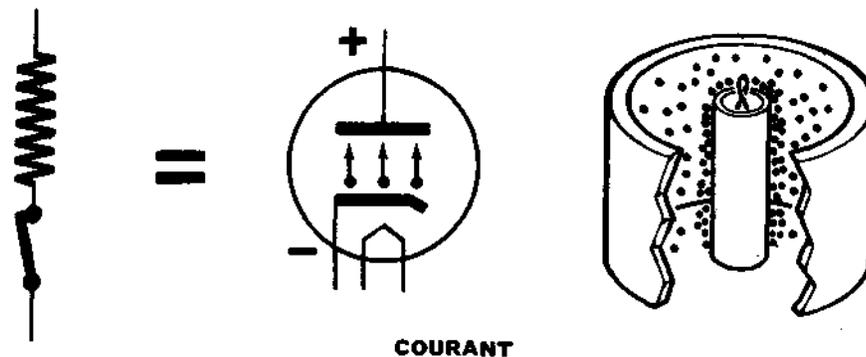
Dès que la plaque devient négative de si peu que ce soit par rapport à la cathode, il n'y a plus aucun flux d'électrons de la cathode vers la plaque. Le tube agit comme s'il était une résistance montée en série avec un interrupteur et que l'interrupteur était ouvert.
