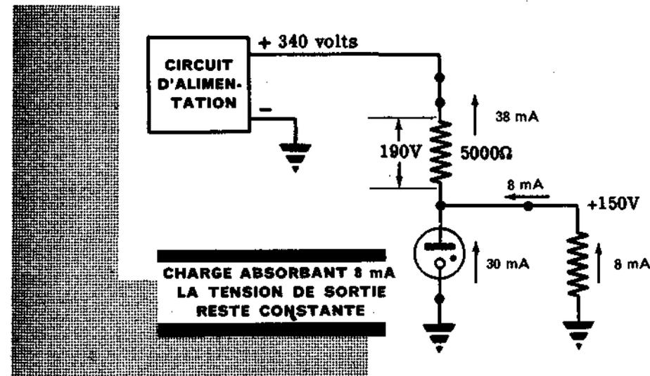
Si vous réglez maintenant la charge branchée sur la prise de 150 volts jusqu'à ce qu'elle consomme 18 mA, le courant dans le tube régulateur va être de 20 mA, et la tension de sortie va rester à 150 volts. Tant que le courant dans le tube régulateur reste entre 5 et 40 mA, le tube est en mesure d'adapter sa résistance interne de sorte que la tension anodique reste sensiblement constante à 150 volts.
