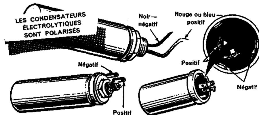
Il existe deux types de condensateurs électrolytiques : (1) les condensateurs à électrolyte liquide et (2) les condensateurs à électrolyte sec.
