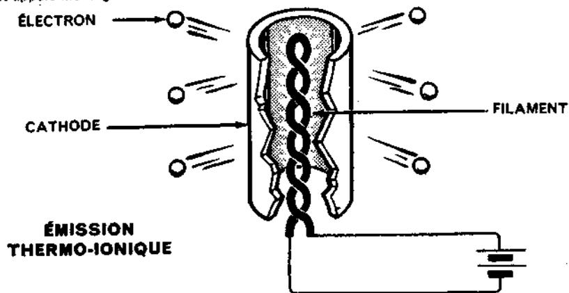
Certains tubes à vide, tels que le redresseur de Fleming ou le redresseur du type 80, comportent des cathodes chauffées directement. Cela signifie que le filament n'est pas entouré par un boîtier, mais qu'il émet lui-même des électrons.
