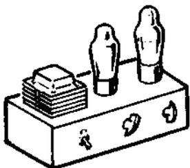
**CIRCUIT REDRESSEUR D'UNE ALTERNANCE** — C'est un circuit redresseur qui utilise un seul élément de rectification, lequel transforme le courant alternatif en courant unidirectionnel en ne permettant le passage du courant que dans un seul sens. Il utilise seulement une demi-période sur deux du courant alternatif, d'où il résulte un courant pulsé unidirectionnel. Ce genre de circuit comprend parfois un transformateur pour accroître ou pour diminuer la tension de sortie.
