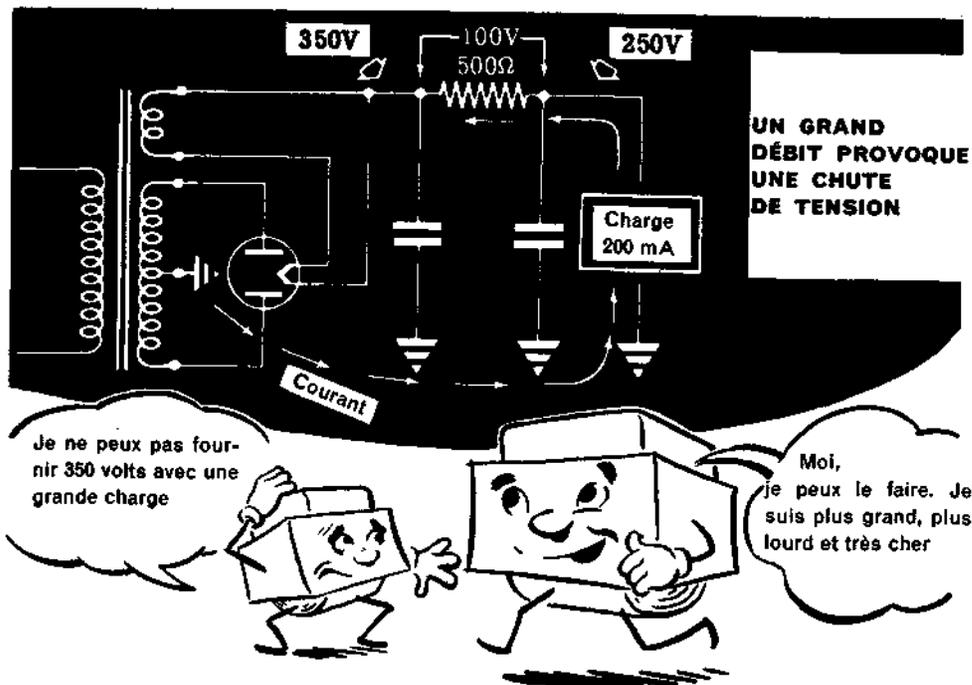
Vous avez vu que l'un des inconvénients du filtre RC consistait à provoquer une importante chute de tension dans la résistance de filtrage, ce qui obligeait le transformateur à fournir une tension alternative plus élevée pour compenser cette perte. Le deuxième inconvénient du filtre RC est encore plus grave. Il consiste en ce que tout changement, même petit, du courant débité provoque une variation importante de la tension de sortie +B.
