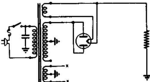
**COURANT DANS UN CIRCUIT REDRESSEUR D'UNE ALTERNANCE** — On applique une tension alternative à la plaque du redresseur, et celui-ci n'est traversé par un courant que pendant les demi-périodes pour lesquelles la plaque est positive.
