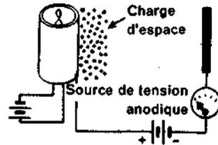
**TUBE REDRESSEUR** — Le tube redresseur est un tube à vide construit spécialement pour être utilisé comme redresseur.
