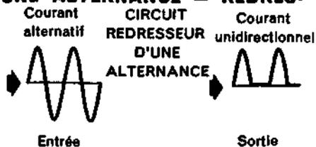
**REDRESSEURS SECS** — Le redresseur sec est un dispositif qui se compose de deux substances métalliques différentes pressées l'une contre l'autre de façon à ne permettre le passage d'un courant que dans un seul sens. Pour les redresseurs secs, on utilise généralement des combinaisons cuivre-oxyde de cuivre ou fer-sélénium.
