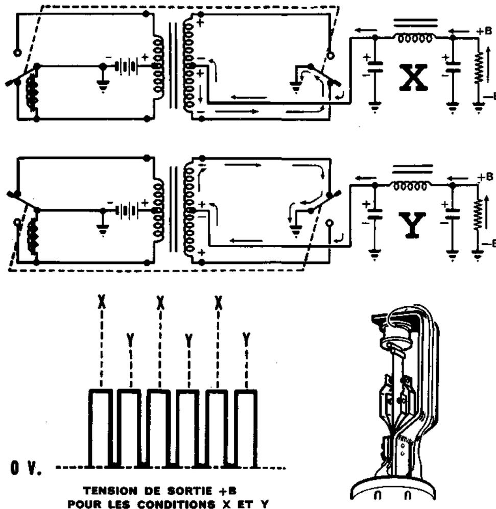
Les deux lames vibrantes représentées dans le diagramme et connectées par un pointillé ne font en réalité qu'une seule lame, placée entre deux paires de contacts. L'action de la lame placée entre les contacts du secondaire produit les mêmes effets qu'un redresseur double alternance. Exactement comme le vibreur non synchronisé, le vibreur synchronisé utilise des selfs de choc et des condensateurs de découplage pour l'élimination des parasites et de l'arc.
