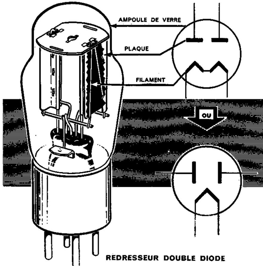
Certains redresseurs comportent des cathodes à chauffage indirect. Le schéma ci-dessous montre un tube redresseur de ce type. Les différents types de tubes sont identifiés par des numéros, et le numérotage, que vous étudierez plus loin, donne certains renseignements sur le tube. Le redresseur de la page précédente est du type 80, et celui que vous voyez ci-dessous est un 117Z6-GT.
