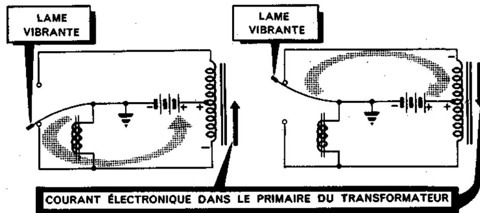
Lorsque la lame vibrante touche le contact inférieur, elle court-circuite la bobine de l'électro-aimant. Il en résulte la disparition du champ magnétique. Puisque l'électro-aimant ne peut plus maintenir la lame vibrante contre le contact inférieur, la lame effectue un mouvement qui lui fait dépasser sa position initiale et la met en contact avec le contact supérieur. Lorsque la lame touche le contact supérieur, il se produit ce qui suit :
