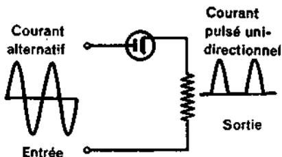
**REDRESSEUR À UNE ALTERNANCE À TRANSFORMATEUR** — Ce circuit utilise un transformateur pour alimenter un tube redresseur avec une tension alternative élevée. Le tube redresseur transforme cette tension en une tension pulsée élevée.
