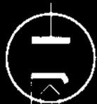
Un circuit d'alimentation qui utilise une diode à vide poussé a une **MAUVAISE** régulation
