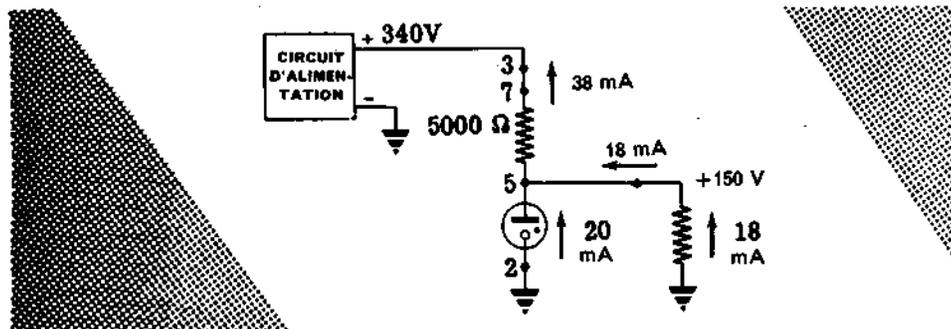
Dans des conditions de fonctionnement comme celles illustrées ci-dessus, 38 mA passent par la résistance chutrice, 20 mA par le tube régulateur et 18 mA par la charge. Si la tension +B montait jusqu'à 360 volts, le tube régulateur devrait ré-adapter sa résistance de sorte que sa tension anodique reste de 150 volts. Voyons si le tube régulateur est capable de faire cette adaptation.
