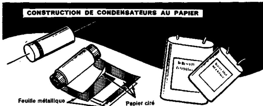
Les condensateurs au papier ne sont pas polarisés et, lorsqu'on s'en sert dans les limites de leur tension nominale, ils durent beaucoup plus longtemps que les condensateurs électrolytiques. Cependant, les condensateurs au papier de fortes valeurs sont volumineux et coûtent relativement cher. C'est pourquoi on ne fabrique généralement pas de condensateurs au papier de plus de  $16 \mu\text{F}$ .
