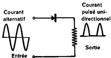
**TUBE REDRESSEUR** — Le tube redresseur est un tube à vide à deux électrodes qui se compose d'une anode et d'une cathode, et qui ne permet un courant que dans le sens de la cathode vers l'anode, agissant ainsi comme redresseur.
