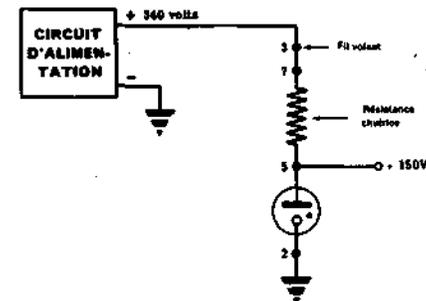
**CONNEXION VOLANTE DU TUBE RÉGULATEUR** — La fonction du fil volant du tube régulateur consiste à empêcher une tension non régulée d'arriver à un circuit électronique spécial, lorsque le tube régulateur est déconnecté. Sans le fil volant, la tension non régulée arriverait au circuit, y provoquerait un fonctionnement incorrect et entraînerait peut-être un dommage. En déconnectant le tube régulateur, on déconnecte aussi le fil volant, ce qui laisse le circuit spécial sans tension.
