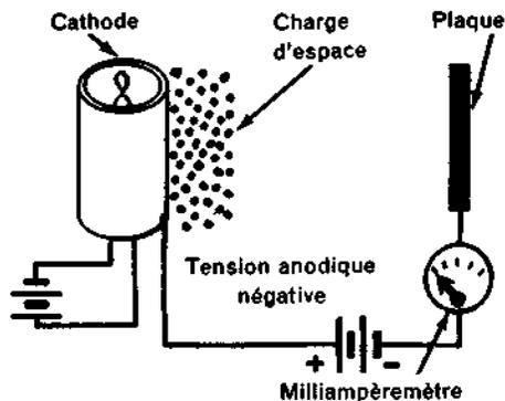
Lorsque la plaque et la cathode sont de potentiel égal, la plaque ne repousse pas les électrons, mais ne les attire pas non plus. Il en résulte que le courant reste nul.
