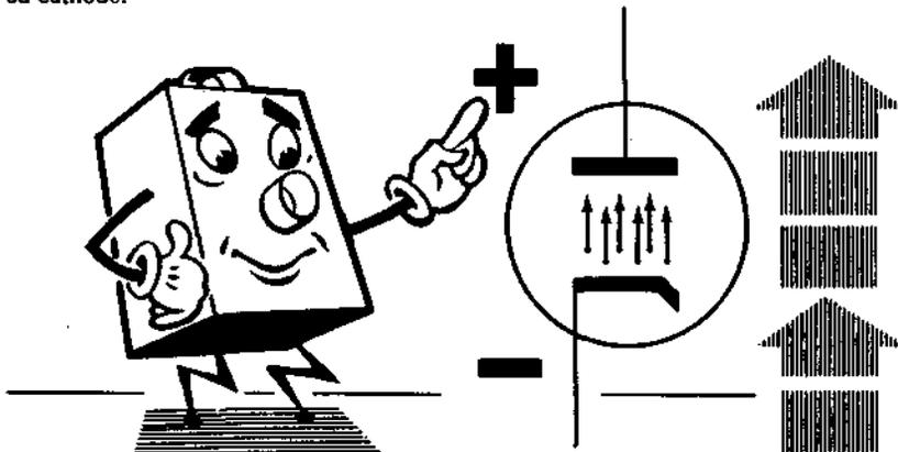
2. La diode ne peut être traversée par des électrons lorsque sa plaque est négative par rapport à la cathode.
