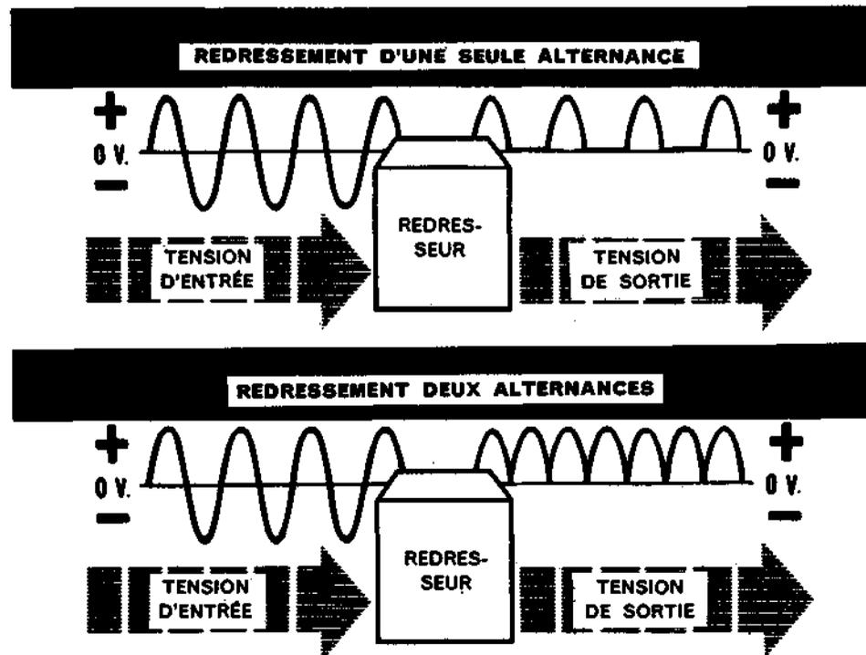
Remarquez que la tension de sortie n'est pas une tension continue constante, mais elle croît et décroît en même temps que la tension d'entrée alternative. Lorsqu'on ne laisse passer par le redresseur que les demi-périodes positives de la tension d'entrée et non pas les demi-périodes négatives, on appelle ce procédé « redressement d'une seule alternance ».
