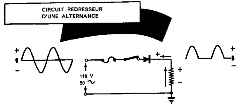
Pour inverser la polarité de la tension unidirectionnelle obtenue, on inverse le redresseur. Le passage du courant n'est alors possible que dans le sens opposé à celui du circuit précédent. Ce nouveau circuit est utilisé pour obtenir, par rapport à la masse, une tension unidirectionnelle négative. L'extrémité de la résistance de charge, qui a été mise à la masse, est positive.
