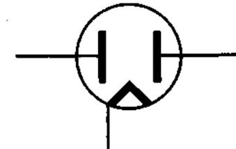
**COURANT DANS LE CIRCUIT REDRESSEUR DOUBLE ALTERNANCE** — Le courant part de la cathode du tube redresseur et se dirige vers celle des plaques qui est positive. Puis, il traverse une moitié du secondaire et arrive à la masse du châssis. A partir de la masse, le courant, après avoir traversé le châssis, se dirige vers l'une des bornes de la résistance de charge qu'il traverse pour regagner la cathode du tube redresseur.
