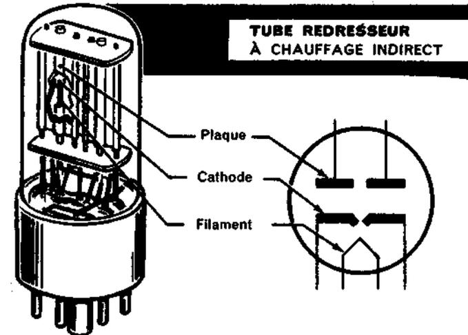
Les tubes à vide sont construits avec un culot à broches adapté au support. Le support est monté sur le circuit de façon permanente, et le tube est amovible et peut facilement être échangé. Par opposition à d'autres dispositifs utilisés en électronique, les tubes à vide ont une vie relativement courte, ce qui implique une facilité maximum de remplacement.
