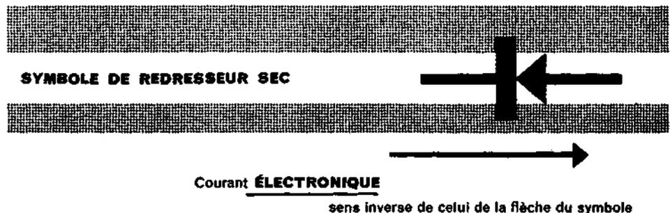
Un élément de redresseur ne supporte qu'une tension très limitée mais on peut augmenter la tension nominale en montant en série plusieurs éléments. De la même manière, chaque élément ne peut être traversé que par un courant limité. Lorsqu'on a besoin d'un courant plus fort, il suffit de monter en parallèle plusieurs jeux d'éléments.
