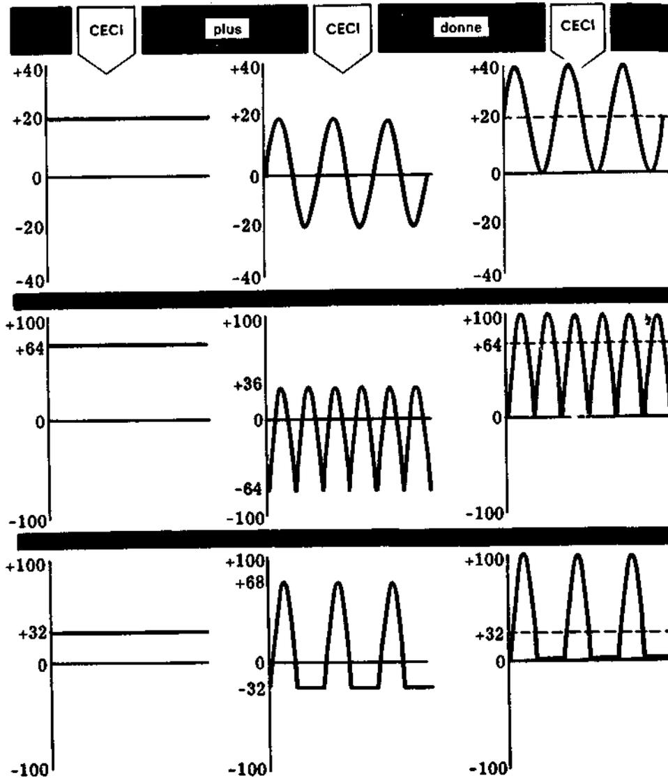
Vous voyez que, chaque fois qu'une tension varie de façon régulière, elle peut être décomposée en une composante continue et une composante alternative. La tension de sortie d'un redresseur comprend effectivement une composante continue et une composante alternative. Le but du filtre consiste à éliminer autant de la tension alternative qu'il est possible et économique, pour que la tension continue élevée qui reste puisse ensuite alimenter les circuits électroniques qui en ont besoin.
