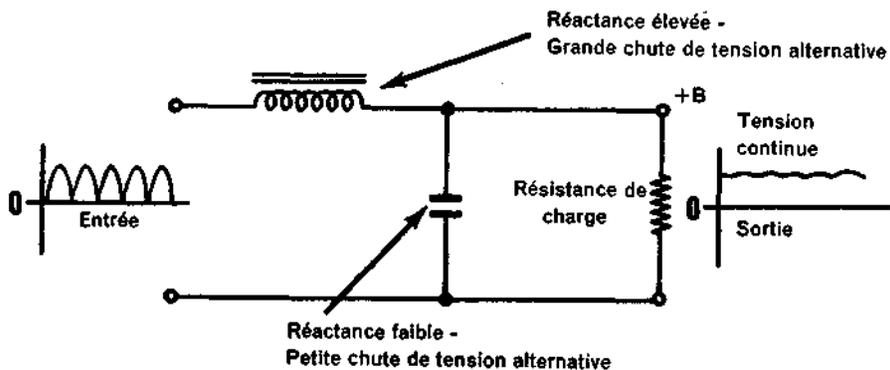
**CIRCUITS FILTRES À SELF DE FILTRAGE EN TÊTE À CELLULE SIMPLE**
