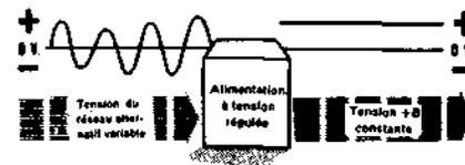
**TUBE RÉGULATEUR DE TENSION** — Le tube régulateur de tension contient une plaque et une cathode, mais pas de filament. La plaque et la cathode sont placées dans une ampoule qui contient un gaz sous faible pression. Lorsque la tension appliquée au tube est suffisamment grande, celui-ci devient conducteur de courant. Tant que le courant dans le tube se maintient dans les limites des valeurs nominales indiquées par le fabricant, la tension anodique reste sensiblement constante.
