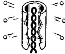
**CHARGE D'ESPACE** — On appelle charge d'espace la charge négative qui entoure la cathode et qui est produite par l'émission d'électrons de la cathode.
