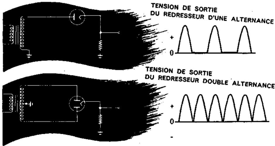
Les circuits électroniques qui sont branchés sur l'alimentation ne peuvent pas utiliser une tension pulsée de ce genre. Il leur faut une tension continue constante avec aussi peu d'ondulation que possible. Le but du filtre est d'éliminer les pulsations de la tension de sortie du redresseur et de fournir une tension continue constante.
