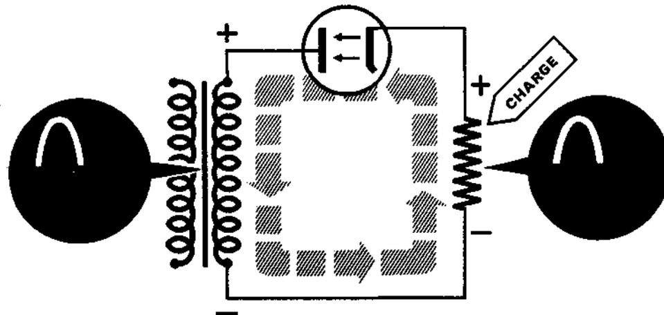
Lorsque la tension obtenue par le transformateur rend la plaque négative, il ne peut se produire un flux d'électrons et, par conséquent, il n'y a aucune tension aux bornes de la charge.
