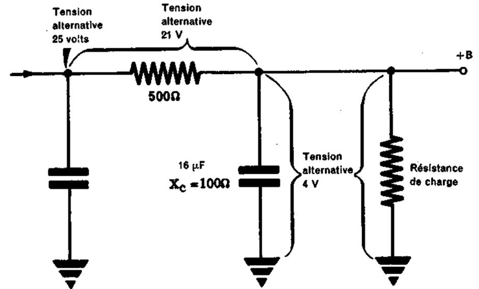
Vous voyez que, par simple addition d'une résistance de 500 ohms et d'un autre condensateur de filtrage, on a réussi à abaisser l'ondulation jusqu'à 4 volts qui représentent environ 1 pour cent de la totalité de la tension de sortie. Cet effet de filtrage est satisfaisant pour la plupart des appareils électroniques.
