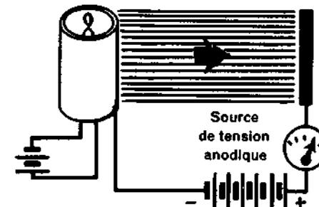
Lorsque ce point est atteint, une nouvelle augmentation de tension de la plaque ne provoque plus une augmentation de courant. Le courant ne peut plus augmenter parce que la cathode émet son maximum d'électrons. Il est ANORMAL d'appliquer à une diode une tension anodique si élevée que des changements de la tension anodique ne provoquent plus de changements du courant anodique.
