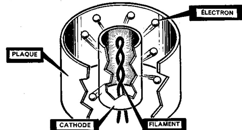
En faisant le vide à l'intérieur du tube, on n'empêche pas seulement le filament de griller, mais on empêche également les molécules d'air de se mêler au flux d'électrons qui va de la cathode vers la plaque. Parfois, on remplace l'air par un gaz inerte qui favorise le passage des électrons au lieu de s'y opposer.
