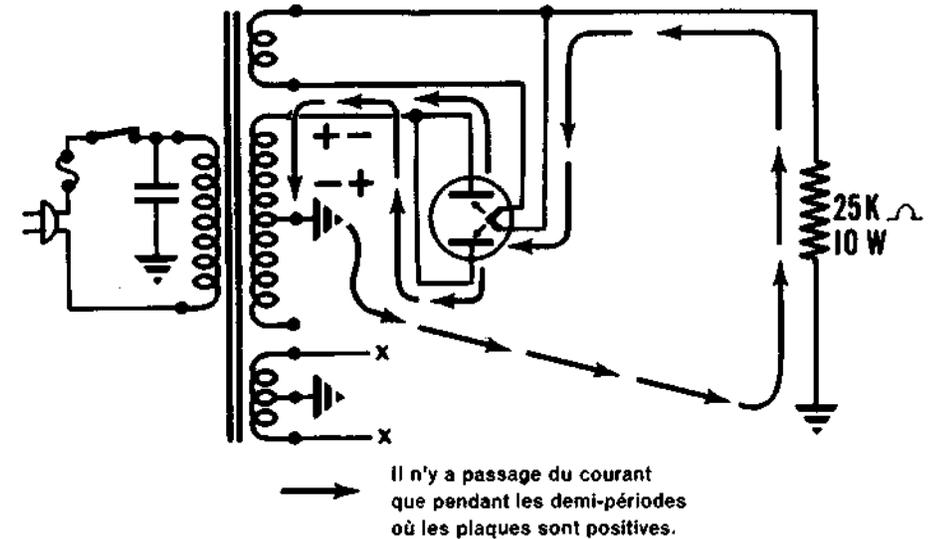
Le condensateur de  $0,001\ \mu\text{F}$  utilisé dans le circuit ci-dessus ne détermine pas l'action du circuit comme redresseur d'une alternance. Il est inséré entre un pôle du réseau alternatif et la masse pour réduire les parasites électriques et pour éviter que ces parasites ne passent dans le circuit redresseur. Les condensateurs destinés à cet usage peuvent être montés de plusieurs manières, comme vous le voyez ci-dessous.
