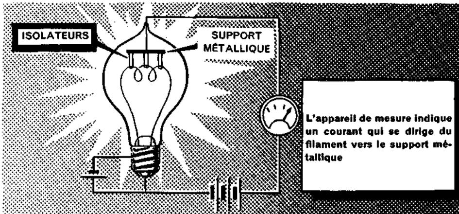
Comme on ne savait encore rien de l'existence des électrons, Edison ne pouvait pas comprendre l'importance de sa découverte, et il fallut 21 ans avant que Fleming, un chercheur anglais, comprît la signification de ce flux d'électrons. Fleming observa que le courant ne se produisait que dans un seul sens. C'est pourquoi il appela son tube à vide « tube redresseur ».
