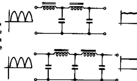
**CIRCUIT D'ALIMENTATION COMPLET** — Un circuit d'alimentation complet se compose d'un redresseur à double alternance et d'un filtre qui servent à alimenter d'autres circuits avec des tensions continues élevées.
