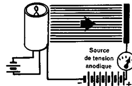
Si nous augmentons maintenant la tension de chauffage au-dessus de sa valeur normale, nous donnons à la cathode la possibilité d'émettre un plus grand nombre d'électrons et, en conservant la même tension anodique qu'auparavant, nous voyons augmenter le courant anodique.
