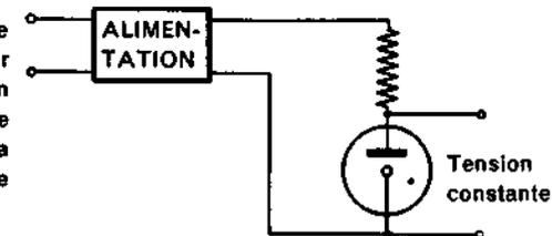
**AUTRES CIRCUITS D'ALIMENTATION** — Pour répondre à des exigences spéciales quant à la taille, au poids, à la source de tension disponible et au courant de charge nécessaire, il existe des circuits d'alimentation sans transformateur et sans self, des circuits d'alimentation par vibreurs, par convertisseurs et par commutatrices, ainsi que d'autres types de circuits spéciaux d'alimentation.
