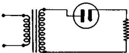
**CIRCUIT REDRESSEUR DOUBLE ALTERNANCE** — Ce circuit utilise un transformateur et un redresseur à double diode pour fournir une tension continue pulsée double alternance, après avoir été alimenté avec une tension alternative.
