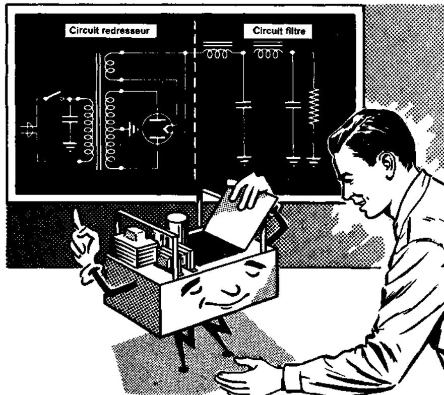
Vous savez déjà qu'il n'existe que deux types de circuit redresseur qui sont généralement employés : les redresseurs d'une alternance et les redresseurs double alternance. Tous deux transforment du courant alternatif en courant pulsé unidirectionnel. Les circuits filtres qui sont généralement utilisés sont de trois types. Ces trois types ont un trait commun, qui consiste à éliminer les ondulations du courant pulsé tel qu'on l'obtient à partir du circuit redresseur.
