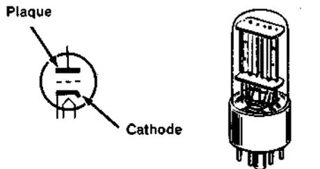
**CIRCUIT REDRESSEUR À TUBE À VIDE** — Ce circuit se compose d'un tube à vide à deux électrodes montés en série avec une source de courant alternatif, et il sert à transformer du courant alternatif en courant continu pulsé.
